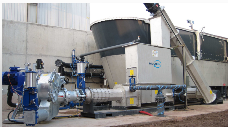
Il MULTIMix frantuma i substrati e separa i corpi estranei.
